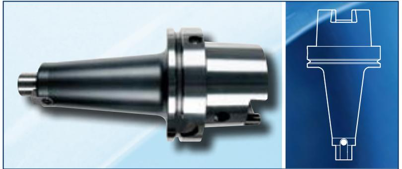
▶ Hohlschaftkegel HSK 80 nach DIN 69893, Form A, für automatischen Werkzeugwechsel, hohe Wiederholgenauigkeit und feste axiale Positionierung durch Plananlage zur Maschinenspindel
