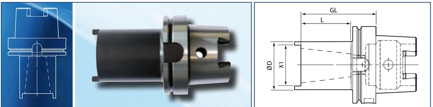
▶ Hohlschaftkegel HSK 100 nach DIN 69893, Form A, für automatischen Werkzeugwechsel, hohe Wiederholgenauigkeit und feste axiale Positionierung durch Plananlage zur Maschinenspindel
