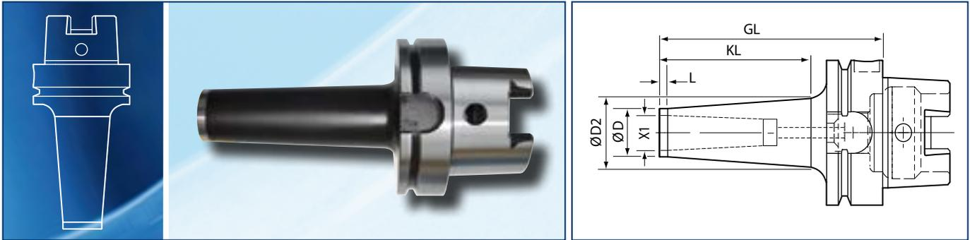
▶ Hohlschaftkegel HSK 63 nach DIN 69893, Form A, für automatischen Werkzeugwechsel, hohe Wiederholgenauigkeit und feste axiale Positionierung durch Plananlage zur Maschinenspindel
