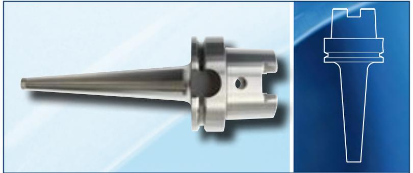
▶ Hohlschaftkegel HSK 63 nach DIN 69893, Form A, für automatischen Werkzeugwechsel, hohe Wiederholgenauigkeit und feste axiale Positionierung durch Plananlage zur Maschinenspindel
