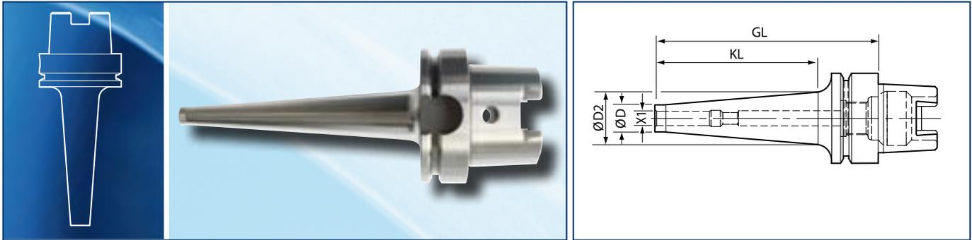
▶ Hohlschaftkegel HSK 80 nach DIN 69893, Form A, für automatischen Werkzeugwechsel, hohe Wiederholgenauigkeit und feste axiale Positionierung durch Plananlage zur Maschinenspindel
