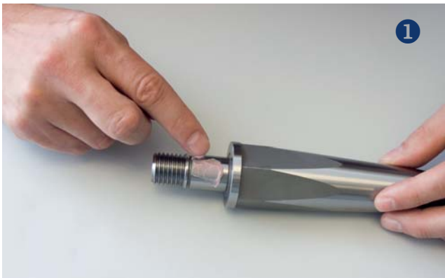
Auftragen der Montagepaste (Paste XK)
