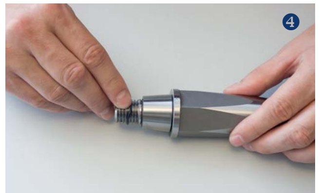
Anbringen des Sicherungsringes (SG) in vorgesehene Nut
