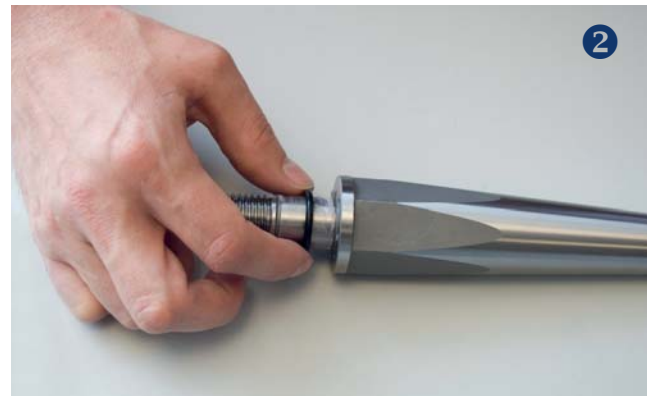
Aufschieben der Gummifeder (PG)
